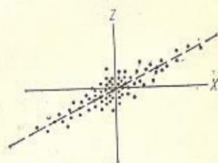
3.11b. Диаграмма рассеивания для двух переменных, значения которых согласованы в значительной степени. Прямая линия, проходящая через точки, может быть использована для предсказания ожидаемого значения Z при заданном конкретном значении X .
