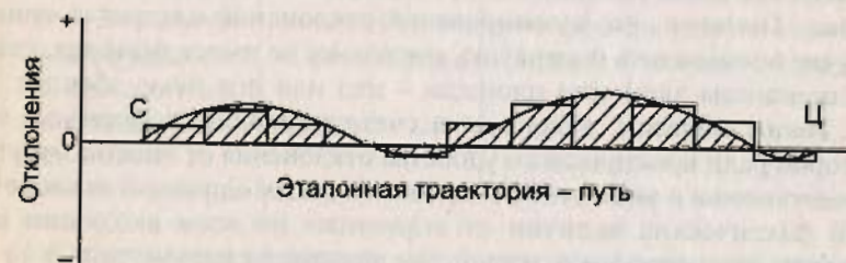
Рис. 1.2. Интегральный критерий качества автоматического управления (заштрихованная площадь)
