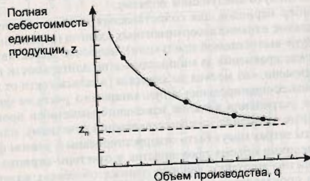
Рис. 7.2. Аналитическая зависимость полной себестоимости единицы продукции от общего объема ее производства
