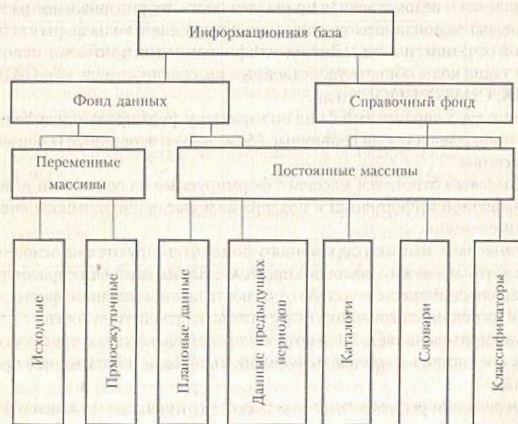
Рис. 5.2. Структура массивов информационной базы регламентных задач
