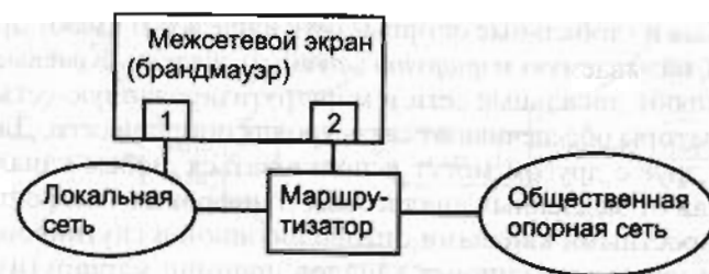
Рис. 1.27. Схема безопасного подключения к глобальной сети
