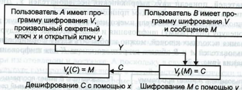
Рис. 5.3. Схема открытого шифрования
