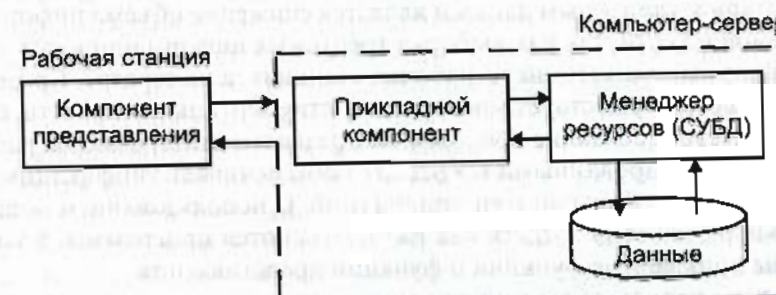
Рис. 1.7. Модель комплексного сервера
