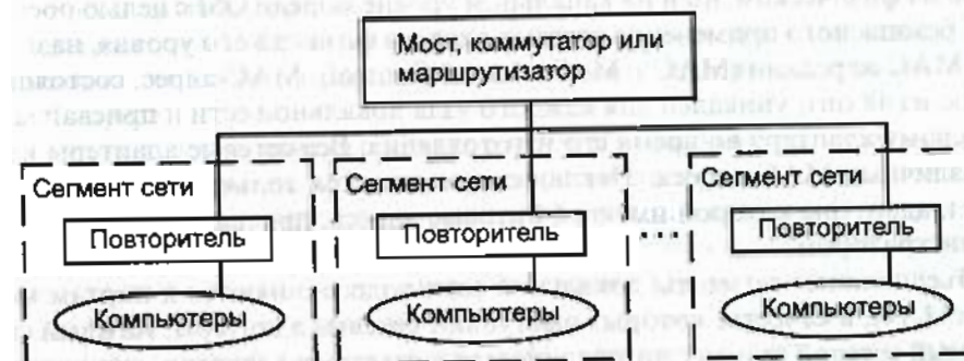
Рис. 1.13. Схема подключения сетевых сегментов
