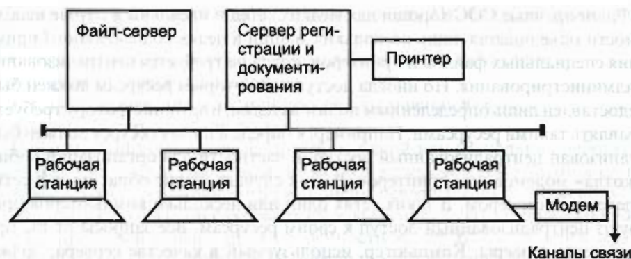
Рис. 1.16. Схема локальной вычислительной сети с общей шиной и выделенными серверами
