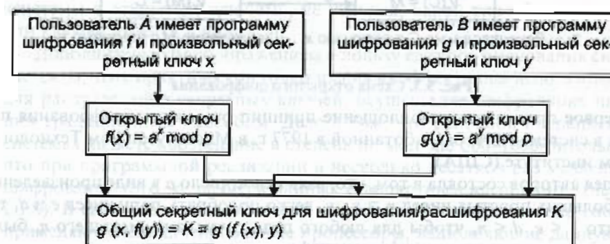
Рис. 5.2. Схема формирования общего секретного ключа
