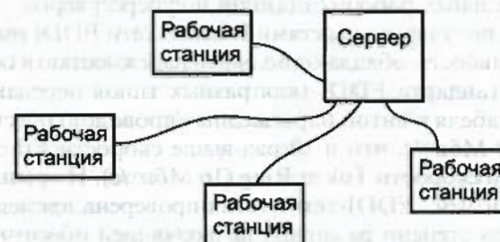
Рис. 1.18. Локальная сеть с топологией «звезда»
