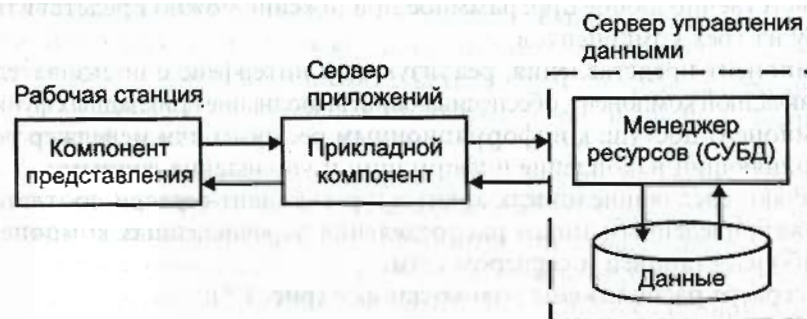
Рис. 1.8. Трехзвенная архитектура «клиент-сервер»
