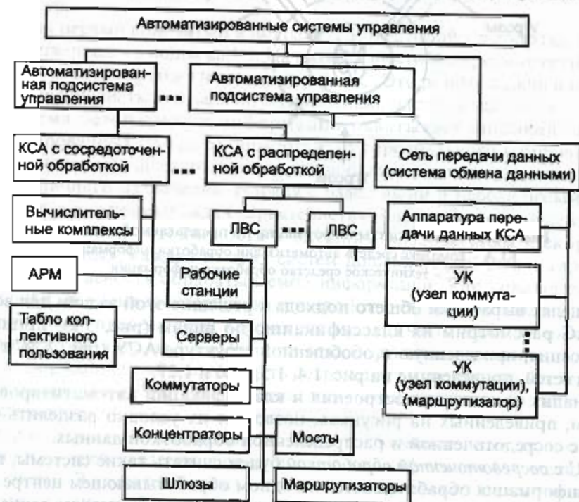
Рис. 3.3. Обобщенная структура автоматизированной системы управления:
