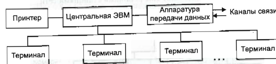
Рис. 1.3. Архитектура первых вычислительных систем
