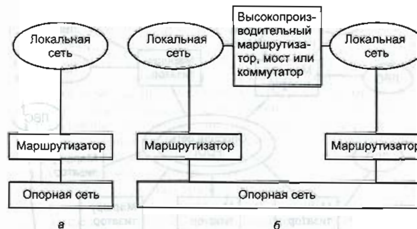
Рис. 1.24. Схемы подключения к опорной сети:
