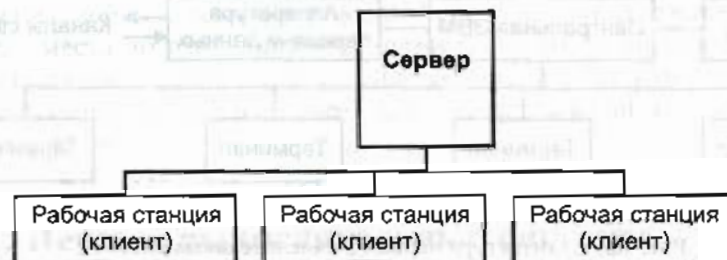
Рис. 1.4. Типовая архитектура «клиент-сервер»
