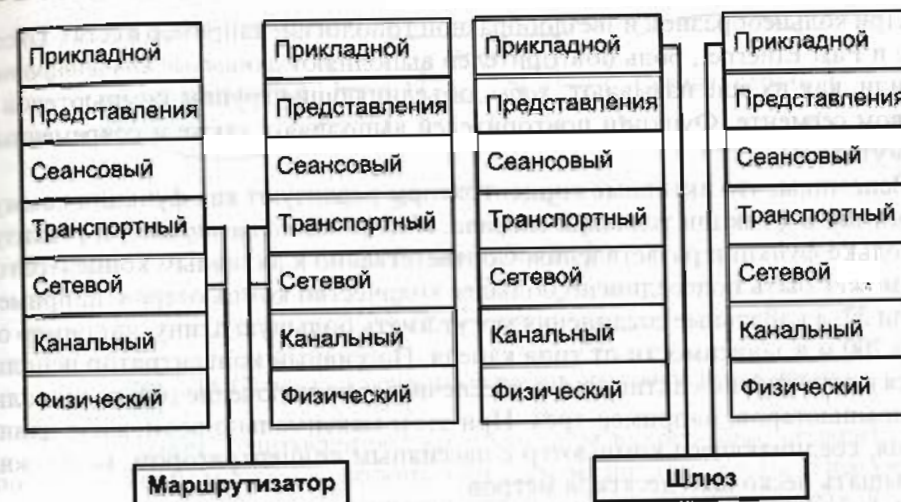
Рис. 1.12. Уровни модели OSI, на которых функционируют маршрутизаторы и шлюзы
