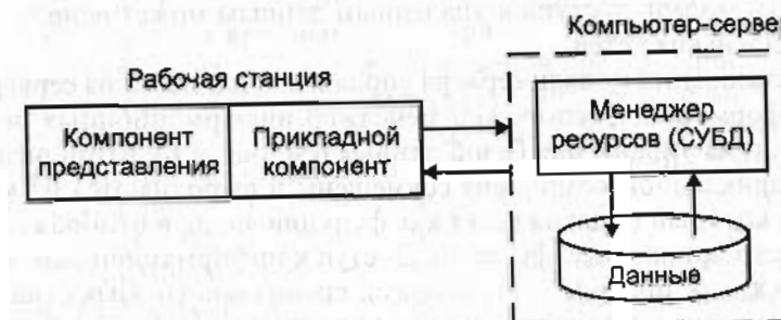
Рис. 1.6. Модель сервера управления данными
