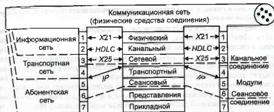
Рис. 1.10. Эталонная модель открытых систем:
