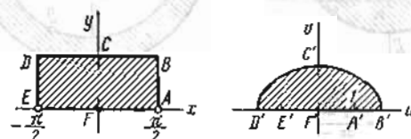
Рис. 11. w = \sin z ; BCD ; y = k . B'C'D' есть полуэллипс
